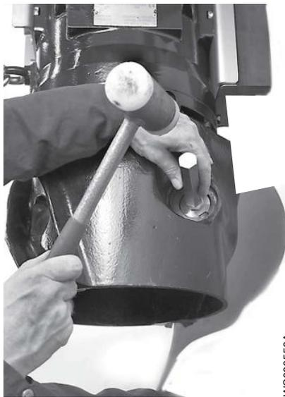
3. Осторожно раскачивая лопасть, выньте ее из муфты. Осторожно вытяните лопасть, чтобы не уронить ее.
